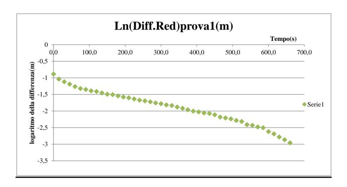
Qui abbiamo l'andamento dell'altezza effettiva della schiuma della prima birra(Red), e il logaritmo relativo ad essa ,nella <u>seconda prova</u>:
